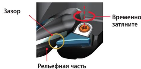
Рис. 2, Установка пластин
