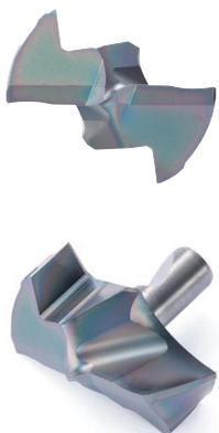
В глухом отверстии остается необработанный участок из-за наличия фаски на периферии
