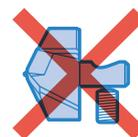
\*1: при каждой замене очищайте гнездо пластины с помощью сжатого воздуха.
